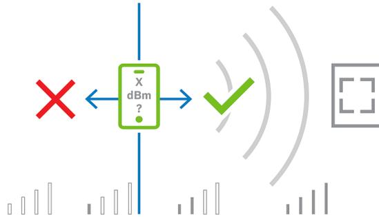
Os valores de RSSI podem variar muito dependendo de diversos fatores, incluindo o tipo de dispositivo de transmissão, o nível da bateria e o material e a espessura das paredes nos arredores. Não há relação linear entre o valor de RSSI e a distância entre o transmissor e o receptor.
