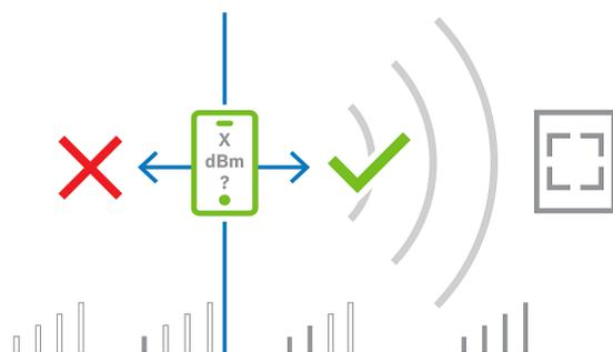
Значения RSSI могут сильно отличаться в зависимости от многих факторов, включая тип передающего устройства, уровень заряда батареи, а также материал и толщину близлежащих стен. Не существует линейной зависимости между значением RSSI и расстоянием между передатчиком и приемником.
