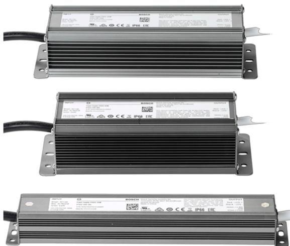
Источники питания PSU-IIR с выходным напряжением 24 В пост. тока предназначены для применения в системах светодиодного освещения. Они обладают защитой от короткого замыкания, перенапряжения, перегрузки по току и перегрева. Каждое устройство имеет кабельные соединения с разделанным проводом длиной 200 мм (8 дюймов).
