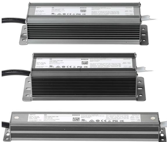
Le unità PSU-IIR sono alimentatori a tensione costante, 24 VDC, progettati per applicazioni con illuminazione LED con protezioni contro cortocircuito, sovratensione e surriscaldamento. Ciascuna unità è dotata di collegamenti dei cavi con fili volanti di ingresso/uscita da 200 mm (8 pollici). Sono disponibili modelli da 35 W, 60 W o 100 W.
