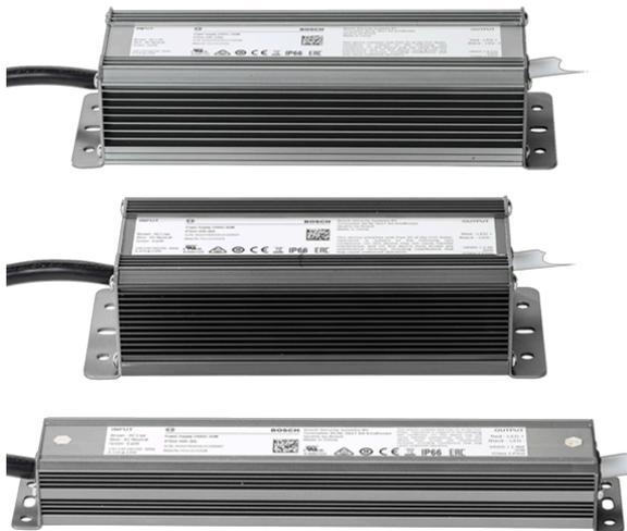
PSU-IIR Einheiten sind 24-VDC-Netzteile mit konstanter Spannung speziell für LED-Beleuchtung mit Kurzschluss-, Überspannungs-, Überstrom- und Überhitzungsschutz. Jede Einheit umfasst Kabelanschlüsse mit 200 mm langen freien Eingangs-/Ausgangskabelenden. Es sind Modelle mit 35 W, 60 W oder 100 W erhältlich.
