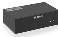
PAED-IM1A是一款音频输出IP模块，可通过标准IP网络接入PAEDUIO公共广播系统，进行音频信号传输。支持PoE供电，使用一根超五类网线接入通用的以太网交换机即可。后背板提供1路音频输出接口，用于连接功放。通过外壳上的螺丝孔位可固定在机柜托盘上，1U高度可并排安装3个IP模块。
