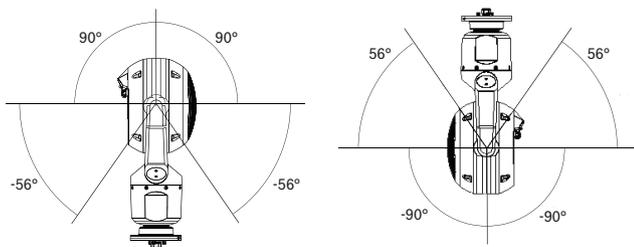
Рис. 1: Диапазон наклона камеры MIC IP fusion 9000i
