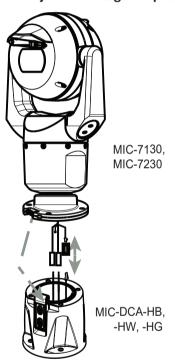
Configuração típica de montagem de um DCA articulado
