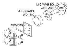
일반적인 기둥 장착 구성 표시되지 않음: 장착 하드웨어. 일반적인 장착 배열, 코너 장착
