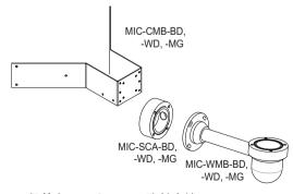
一般的なコーナーへの取付方法 非表示:取付用金具。 一般的な取り付け例、ヒンジ式 DCA の場合
