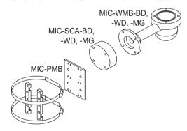
一般的な支柱の取付構成 非表示:取付用金具。
