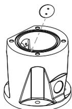
Bosch советует хранить заглушку в монтажном комплекте DCA (или аксессуаре для настенной установки) на случай, если вы решите снять прожектор.
