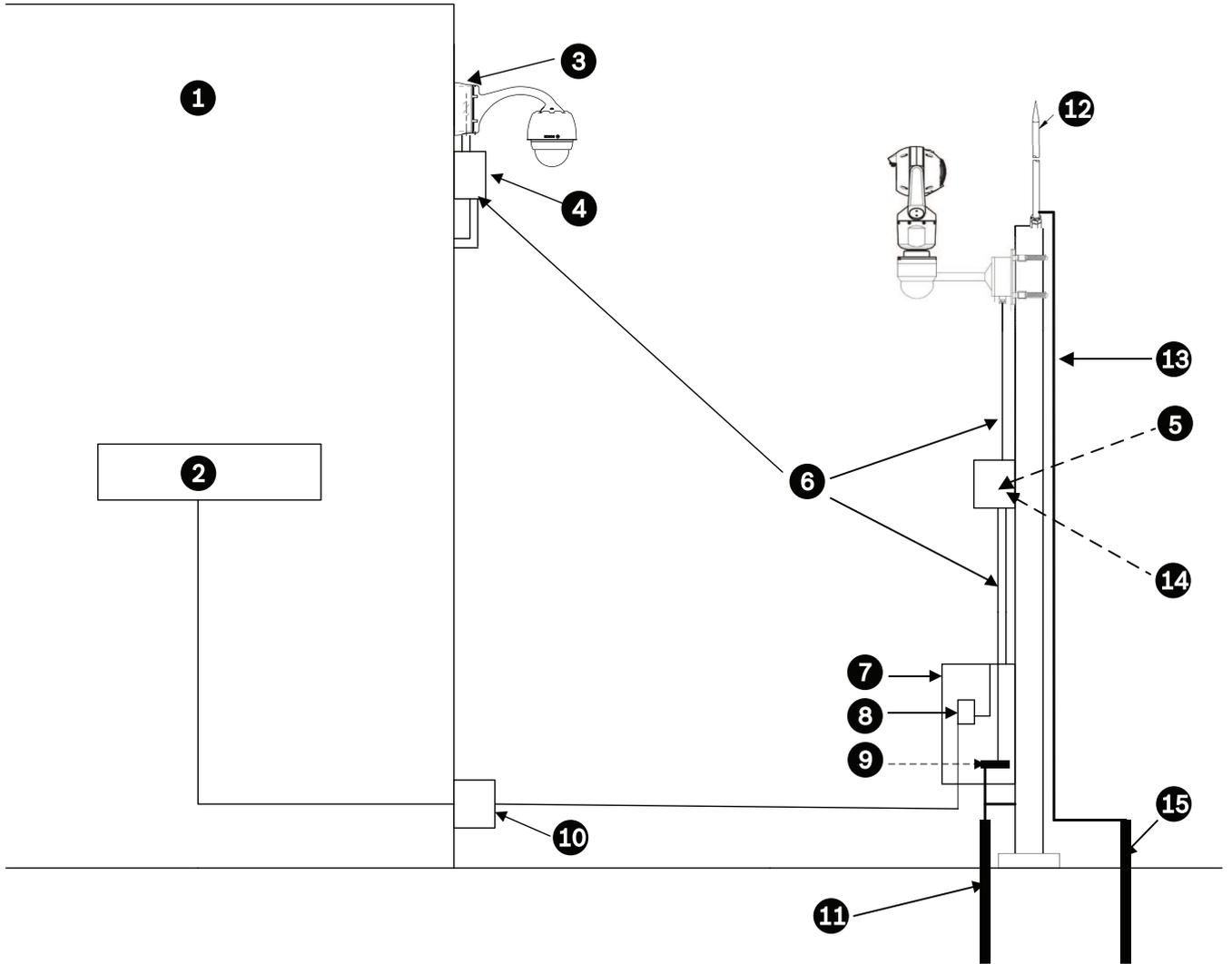
그림 17.1: 적절한 서지/번개 보호가 포함된 올바른 실외 설치
