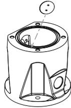
Bosch empfiehlt, den Zugangsstecker in der DCA-Befestigung (oder im Zubehör zur Wandmontage) aufzubewahren, falls es nötig sein sollte, den Strahler zu entfernen.
