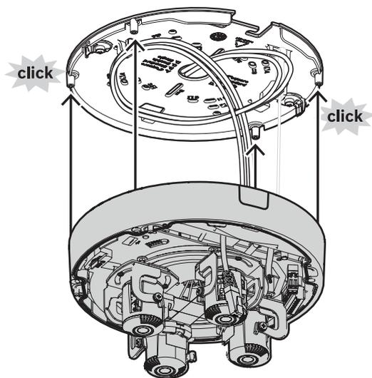
14. Serrez les 4 vis imperdables dans les trous de vis du socle de la caméra entre 4 et 7 Nm.
