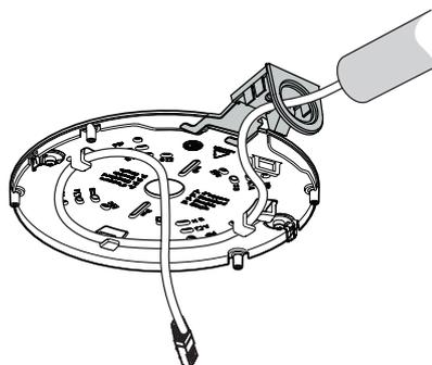
12. Installez le cache de gaine sur la plaque de gaine à l'aide du boulon. Serrez la vis entre 1,4 et 2 Nm avec la clé Allen TR20.
