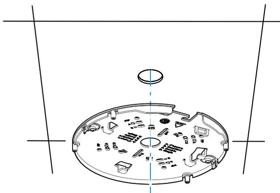
3. Percez les 4 trous au diamètre approprié pour pouvoir utiliser les chevilles et vis de 5-6 mm.
