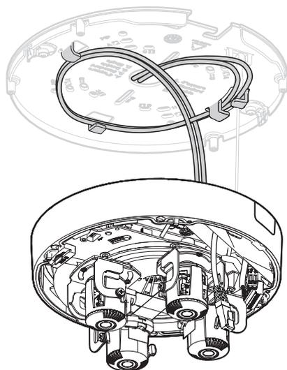
13. Placez le socle de la caméra sur la plaque de montage de sorte en alignant les trous de vis du socle sur ceux de la plaque de montage. Appuyez légèrement sur le socle de la caméra contre la plaque de montage jusqu'à ce que vous entendiez ou sentiez un clic. Assurez-vous que le socle de la caméra est bien fixé.
