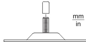
Rebordo de suporte de parede/tecto, incluído com o suporte de paredes/tectos sólidos TC9210U
