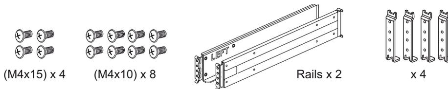
Установка SuperRail в четырехпозиционную стойку с круглыми отверстиями
