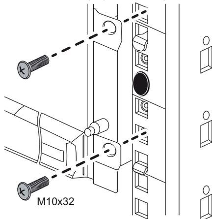
6. Для обоих опор задней части салазок: прикрепите устройство к задней части стойки или корпуса и салазок, вставив винты в отверстие устройства, отверстие стойки или корпуса и отверстие в задней части салазок.
