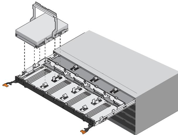
4. Начиная с самого левого отсека на передней панели, выровняйте две поднятые кнопки на диске с вырезами на лотке. Затем, осторожно нажав на верхнюю часть диска, поверните ручку лотка вниз до тех пор, пока диск не встанет на место.
