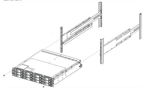
Fissare l'unità alla parte posteriore dei binari inserendo due viti M5 nelle staffe dell'unità e nella staffa del kit di binari.
