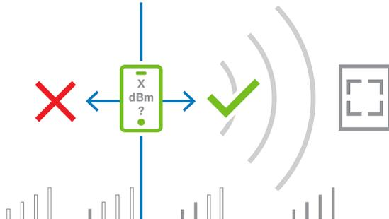
Les valeurs RSSI peuvent varier considérablement en fonction de nombreux facteurs, notamment le type d'appareil de transmission, le niveau de la batterie, ainsi que le matériau et l'épaisseur des murs à proximité. Il n'y a pas de relation linéaire entre la valeur RSSI et la distance entre l'émetteur et le récepteur.
