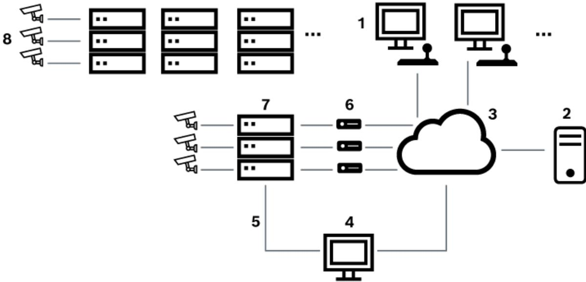
그림 6.5: 위성 스위치로 확장된 Bosch Allegiant 시스템
