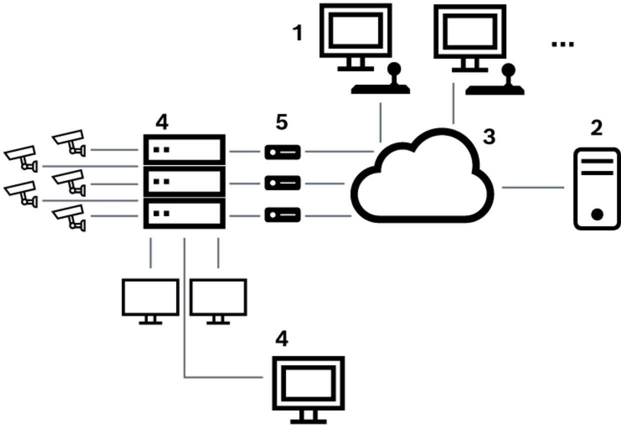
그림 6.4: Bosch Allegiant 매트릭스 스위치에 대한 Bosch Video Management System 원격 연결
