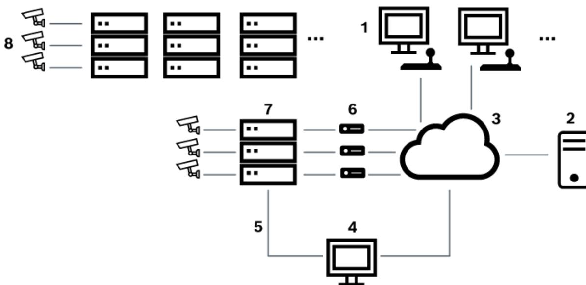
**Figura 6.5:** Sistema Bosch Allegiant esteso con commutatori satellitari
