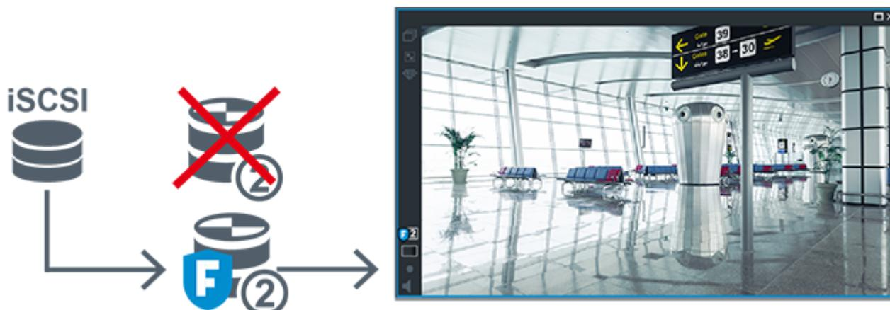
Quando il VRM secondario e il VRM di failover secondario opzionale sono entrambi non collegati, l'encoder fornisce la riproduzione. Chiudere il riquadro Immagine e trascinare nuovamente la telecamera in un riquadro Immagine:
