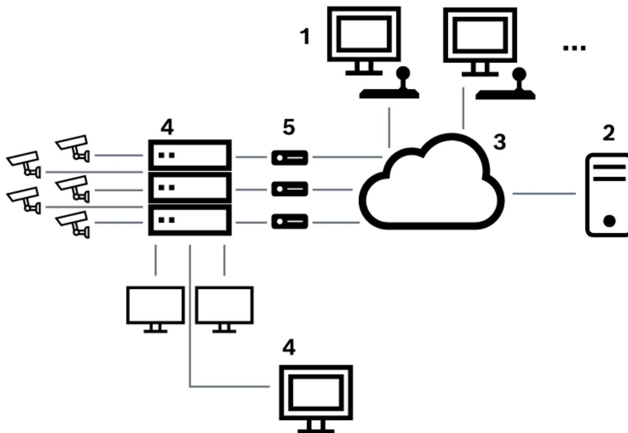
**Figura 6.4:** Collegamento remoto di Bosch Video Management System ad una matrice Bosch Allegiant
