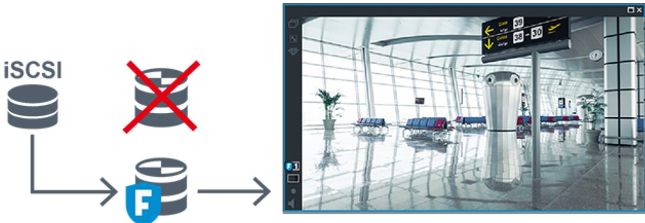
Quando il VRM primario e il VRM di failover primario opzionale sono entrambi non collegati, l'encoder fornisce la riproduzione. Chiudere il riquadro Immagine e visualizzare nuovamente la telecamera in un riquadro Immagine:
