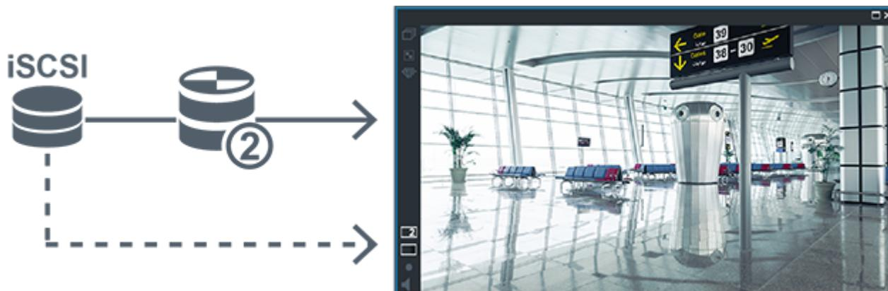
Quando il VRM secondario non è collegato, il VRM di failover fornisce la riproduzione. Chiudere il riquadro Immagine e visualizzare nuovamente la telecamera in un riquadro Immagine:
