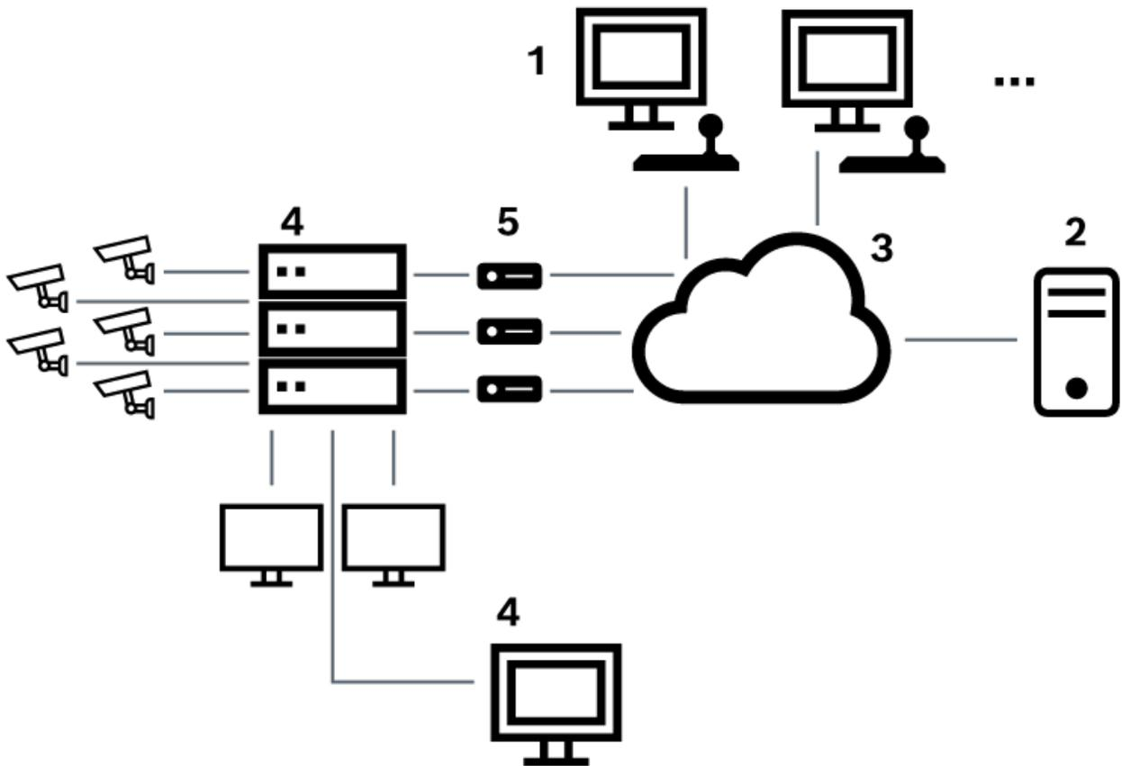
圖片 5.4: Bosch Video Management System 遠端連接至 Bosch Allegiant 矩陣切換器
