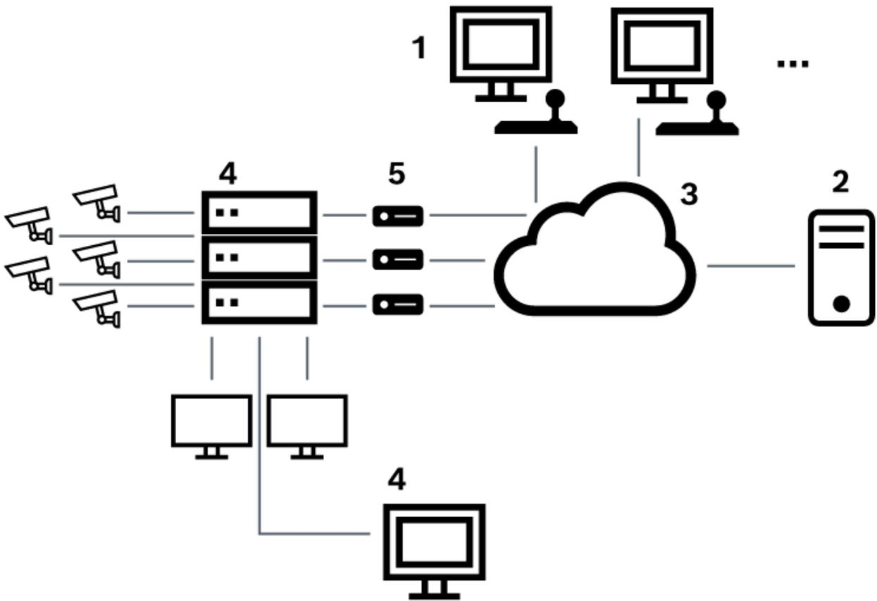
**Figura 5.4: Collegamento remoto di Bosch Video Management System ad una matrice Bosch Allegiant**
