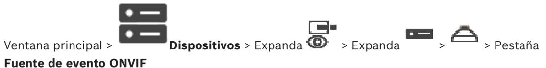
Puede configurar los eventos ONVIF de una fuente (canal de vídeo, entrada o relé). Se agregará una definición de evento a la Tabla de asignación del codificador. Por ejemplo, para un codificador multicanal puede configurar la cámara para la cual se activará un evento **Movimiento detectado**.
