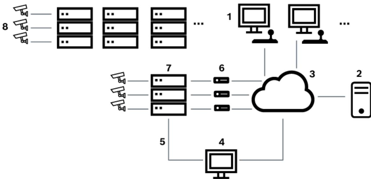
Figura 5.5: Sistema Bosch Allegiant ampliado con matrices satélite
