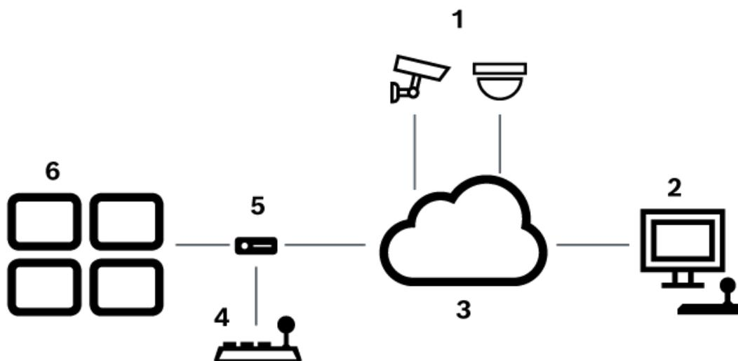
Figura 5.2: Situación 2: teclado IntuiKey de Bosch conectado a un decodificador
