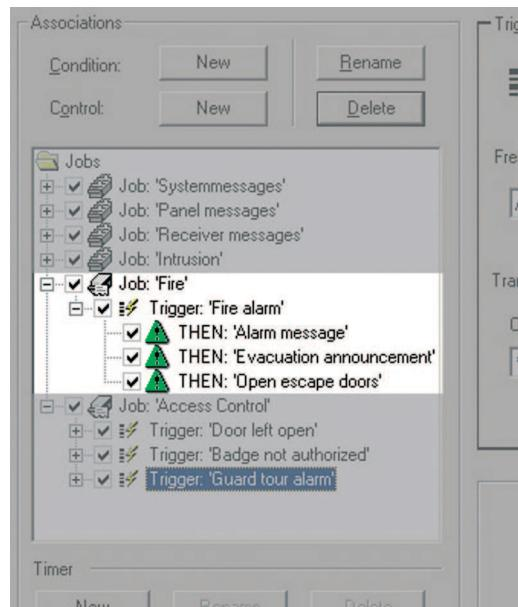
Sistemin merkezi olan Durum Makinesi tüm gelen olayları ve operatör isteklerini izler ve istenirse kullanıcı tarafından tanımlanan kurallarla belirlenen işlemleri yaparak operatörlerin yükünü azaltabilir.
