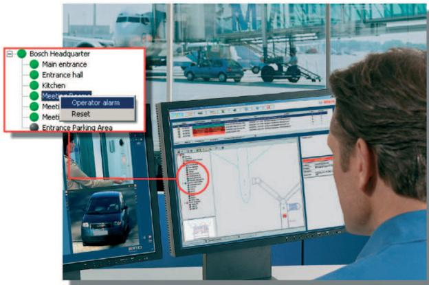
Der **Bedieneralarm** ermöglicht es dem Bediener, einen Alarm über den Ortsbaum manuell auszulösen, falls er z. B. per Telefon über eine Gefahrensituation informiert wird. Solche manuellen Alarme werden genauso verarbeitet wie jene, die von einem Melder ausgelöst werden. Das heißt, es werden die zugehörigen Dokumente angezeigt, und alle Schritte werden für spätere detaillierte Untersuchungen im Logbuch festgehalten.
