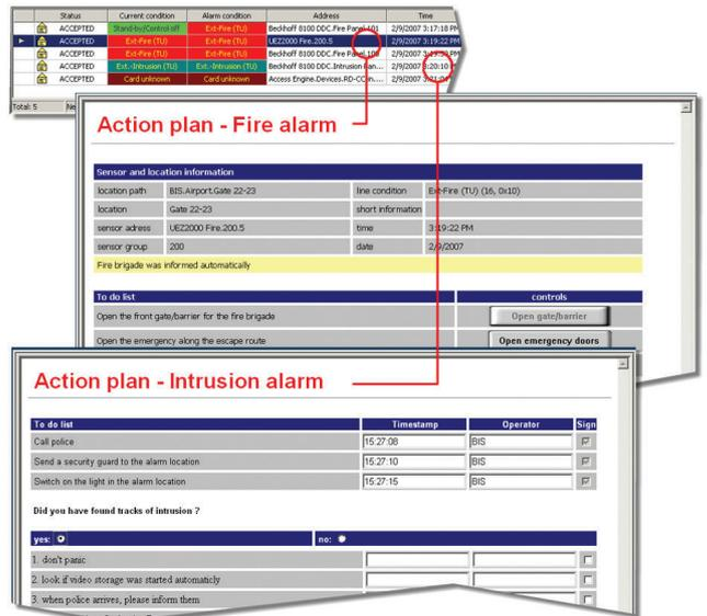
基于报警的操作计划或工作流为操作人员提供有关事件的详细信息，例如标准操作程序、实况图像、控制按钮等。轻松为您系统中可能发生的各种报警类型创建并分配一种操作计划，例如，火灾报警、拒绝进入、技术报警。当删除报警信息时，一个有所显示操作计划的、不可修改的快照将记录到事件日志中。这可以追踪操作员在报警响应期间内执行的所有活动，从而提高操作人员的责任感。
