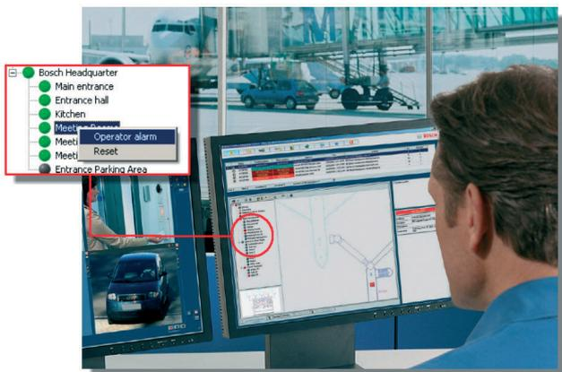
**操作人员报警**功能允许操作人员从位置树手动触发报警，例如，通过电话通知危险情况。此类手动报警的处理方法与探测器触发的报警的处理方法相同：即，显示相关文档，并且在事件日志中记录已采取的所有步骤以便进行深入的事件后调查。
