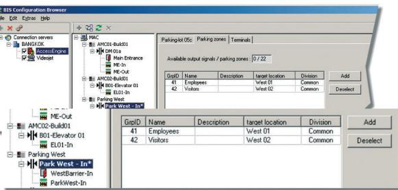
Эта функция позволяет определить и использовать модель дверей «автостоянка», в которой содержатся два ограждения на выход и на вход, а также светофор, препятствующий доступу, когда на автостоянке больше нет свободных мест.
