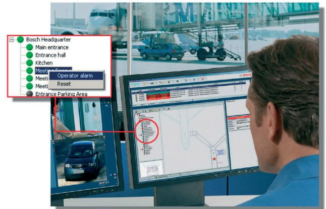
Der **Bedieneralarm** ermöglicht es dem Bediener, einen Alarm über den Ortsbaum manuell auszulösen, falls er z. B. per Telefon über eine Gefahrensituation informiert wird. Solche manuellen Alarme werden genauso verarbeitet wie jene, die von einem Melder ausgelöst werden. Das heißt, es werden die zugehörigen Dokumente angezeigt, und alle Schritte werden für spätere detaillierte Untersuchungen im Logbuch festgehalten.
