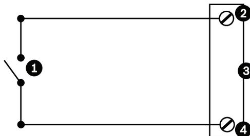
**Figura 10.4:** N.O. - Conexões normalmente abertas não supervisionadas
