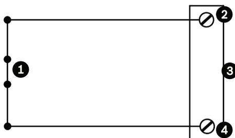
Figure 10.5: N.F. Connexions normalement fermées non supervisées
