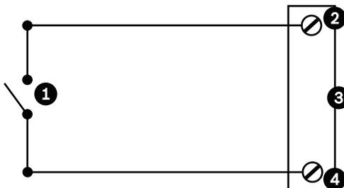
Figura 10.4: N.A. - Conexiones no supervisadas normalmente abiertas
