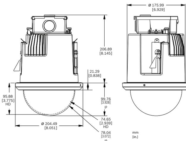
Рис. 1: Серия AUTODOME 7000, кронштейн для потолочного монтажа
