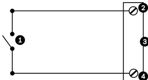
**Figura 13.4: N.O. - Conexões normalmente abertas não supervisionadas**
