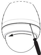
**Figure 12.1: Rainure de déverrouillage de la sphère**
