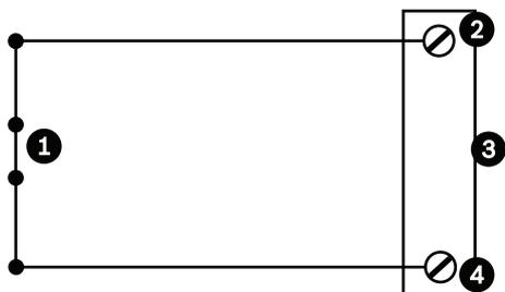
**Figura 10.5: N.C. Conexões normalmente fechadas não supervisionadas**
