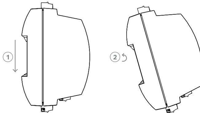
圖片 4.2: 從安裝軌架卸下控制器
