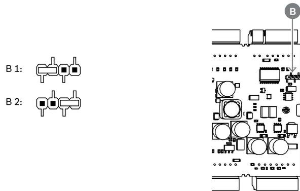
圖片 4.6: 接地跨接線底部的位置
