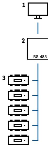
圖片 4.9: RS-485 主機系統的設定
