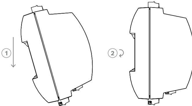
圖片 4.1: 將控制器安裝在安裝軌架上
