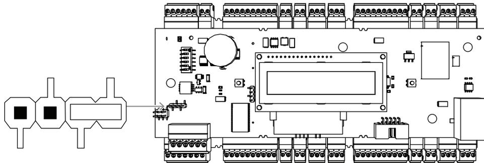
圖片 4.11: RS 485 兩線式連接的跨接線設定
